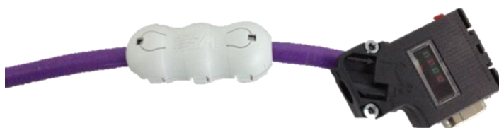
图 2-14: Profibus DP 线缆穿过磁环
