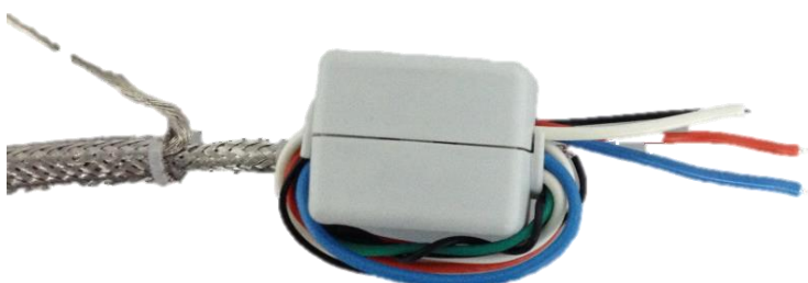
图 2-13: 信号电缆穿过磁环
